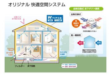
新商品『オリジナル快適空間システム』は、給排気に機械動力を使用する『第一種換気』と熱交換ユニット (エレメント)を通った空気を建物内に取り入れる『全熱交換式』を同時に採用、それにより効率的な換気を行うとともに、換気にともなう室温変化を抑えることで、省エネ効果を発揮します。この商品の開発にあたって、2 社は桧家住宅の実験棟を利用し、風量測定や CO2 濃度測定などの実大実験を行い換気性能に関するデータ 収集を行ったうえで約 1 年をかけて今回の販売にいたりました。
