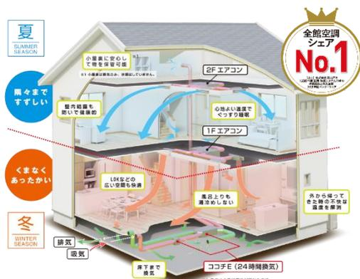
『Z空調』は、ヒノキヤグループの連結子会社(株)日本アクア (<https://www.n-aqua.jp/>) が提供する断熱材『アクアフォーム』で建物の断熱・気密を高め、空調をダイキン工業(株)、換気を協立エアテック(株)が担うことで実現した、快適で経済的な新冷暖房システムです。独自技術により従来の全館空調の導入コストを大幅に下回る販売価格と壁掛けルームエアコン同等の電気代を実現した冷暖システムです。24時間365日、家中どこでも快適な温度を維持することができ、導入されたお客様からも非常に高い評価をいただいています。
