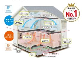
『Z空調』は、ヒノキヤグループの連結子会社㈱日本アクア (https://www.n-aqua.jp/) が提供する断熱材『アクア フォーム』で建物の断熱・気密を高め、空調をダイキン工 業㈱、換気を協立エアテック㈱が担うことで実現した、快適で経済的な新冷暖システムです。
